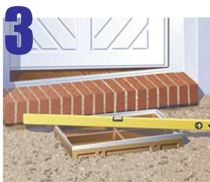
3 Nivele la base *DrainMat*, rellene el borde con concreto y remate la superficie según el acabado (recubrimientos, adoquines, etc.).
